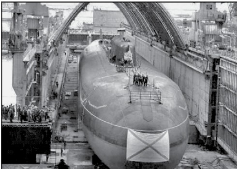
Спуск на воду подлодки «Курск». Кораблю еще предстоит швартовые и государственные испытания.
